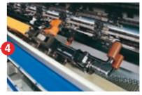
des Lademagazins (bis zu 700mm bei den Modellen Sir25 und Sir36; bis zu 1200mm bei Modell Sir52) ermöglicht einen einfachen Zugang für Wartungszwecke zum Drehautomaten.
