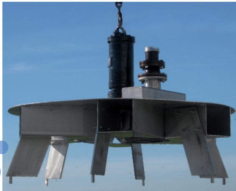
El SOFIE se compone esencialmente de un rotor de paletas en inox (la versión en poliéster es posible) que está optimizado hidrodinámicamente y alojado en un cárter de depresión con canales de salida de aire. El rotor es impulsado por un motorreductor sumergible. El cárter está conectado a una central de aire a presión por medio de una tubería flexible.
