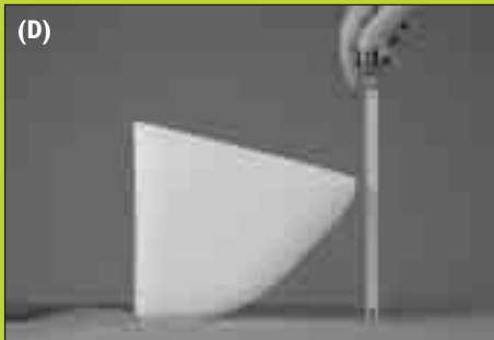
(D) With the elevator bucket back held vertical, measure height to front lip (D). Con la espalda del cangilón vertical, medir la altura hasta el labio frontal (D).
