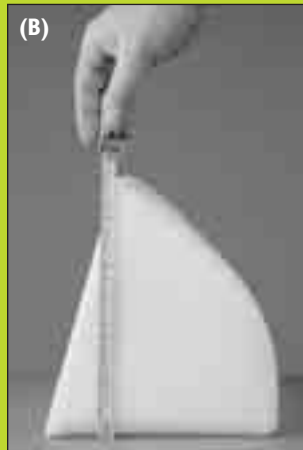
With elevator bucket back laid flat, measure the horizontal projection of the elevator bucket (B). Con la espalda del cangilón plano, medir la proyección horizontal (B).
